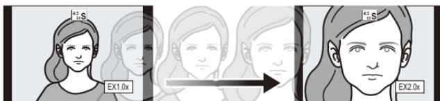
• En utilisant un Objectif interchangeable qui prend en charge le zoom à alimentation, le Convertisseur Télé Extra devient disponible après un zoom avant jusqu'au bout de Téléobjectif du Zoom optique.
