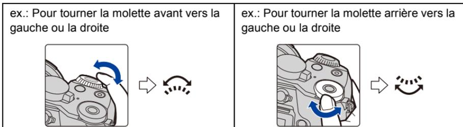
Vous permet de définir l'ouverture, la vitesse d'obturation, et les autres paramètres pour les modes **P / A / S / M**.
