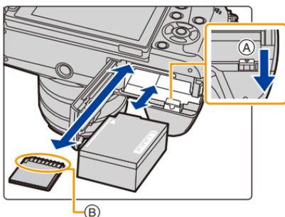
Tirez le levier (A) dans le sens de la flèche pour retirer la batterie.
