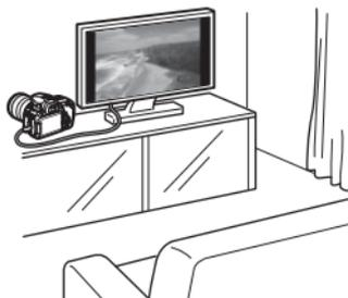
Utilisez le câble vidéo fourni ou un câble HDMI HTC-100 (vendu séparément) afin de raccorder l'appareil photo à un téléviseur. Vous pourrez ensuite visionner les vidéos et photos capturées sur votre téléviseur.
